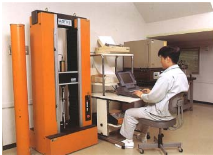
配管用フレキ管引張試験
