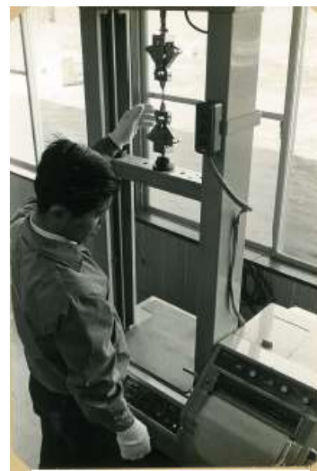
ゴム素材引張試験機
