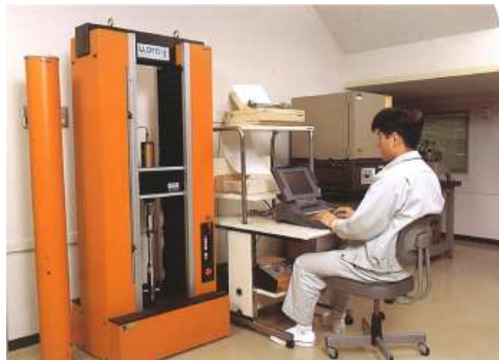
配管用フレキ管引張試験
